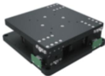
滑台模组的电动特性是什么?滑台模组是数控设备的重要附件之一。主要功能是组装两个滑座台后构成X-Y轴滑座台,两个坐标的定位和联动,传动滑台模组是导轨、滚珠丝杠、电动机座传动滑台模组滑板移动的线性度、滑板平面和移动方向的平行度、滑板平面和底座底部的平行度都必须符合规定的规格。(1)、高精度和高刚度:通过对所有方向的载荷与接触位置的变形量分析,可以知道该精密直线模块的精度高、刚度高的特性。通过有限元法的优化结构设计,得到了很不错的刚度和重量比。(2)、测试可以轻松检测位置准确度、位置再现性、行走平行度、起始扭转等功能。(3)、组装方便,维护方便。组装者即使没有专业的熟练者也能完成组装。灰尘和润滑好,维护方便,机械台报废后提供回收利用。(4)、多任务设计:集成驱动用球螺丝和引|导用U轨道不仅可以提供精密的直线运动,还可以与多功能附件一起使用。在导入多用途应用程序设计时,非常
